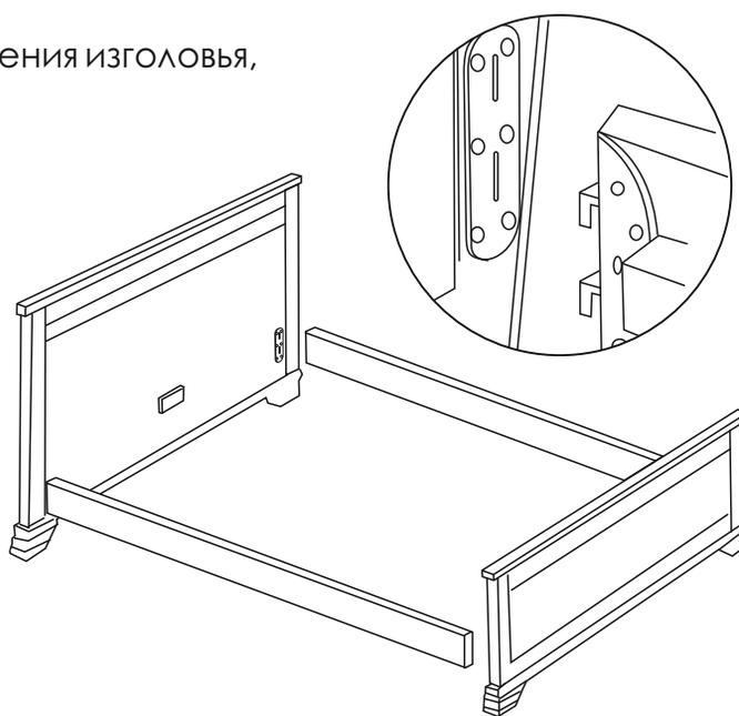
2. Схема установки опоры на среднюю царгу
