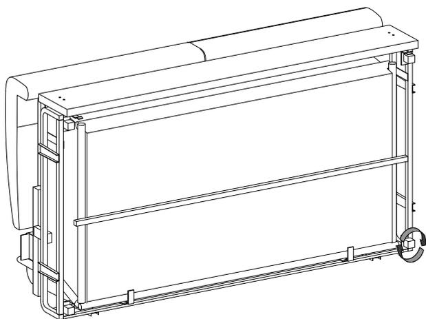
Выкрутить саморезы из транспортировочных опор
