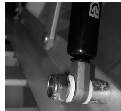
Рисунок 12 (Фторопластовые шайбы и гайка со стопорным кольцом)
